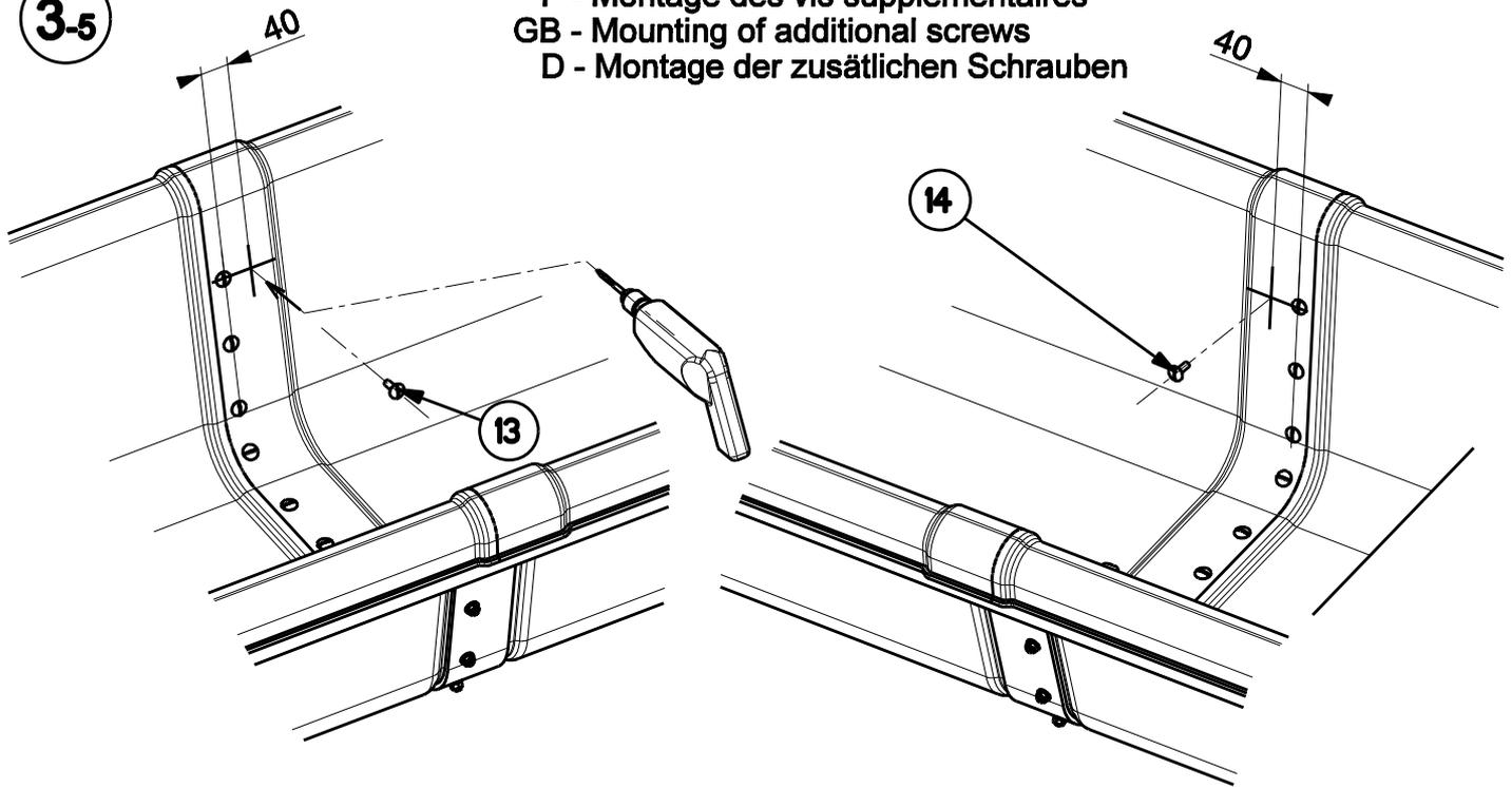
F - Percer 2 trous verticaux à 40 mm, puis assembler.
